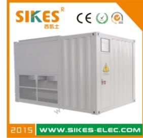
船舶海洋工程电站测试负载箱是用于船用发电机组和燃气机组负载测试，可以精确测试各类发电机组的输出功率与带载能力，主要对发电机组所有电参数包括动态参数进行测试，控制方式有远程笔记本电脑控制（主控制方式），就地手动控制（备用控制方式），采用计算机控制方式，可自动完成对发电机组所有电参数的各项测试，实时显示测试数据，同时生成图表、曲线及检测报告，测试项目全，数据内容丰富为大功率发电机组设备提供了科学的检测手段。
